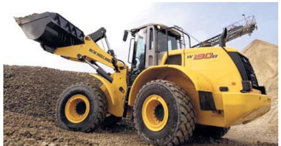
Bei New Holland Radladern sitzt die Kühlergruppe in einer Box hinter dem Fahrerhaus. Der Motor wandert nach hinten und wirkt als Gegengewicht. Das eigentliche Gegengewicht kann kleiner ausgelegt werden. Ergebnis: 8-10% weniger Kraftstoffverbrauch!
