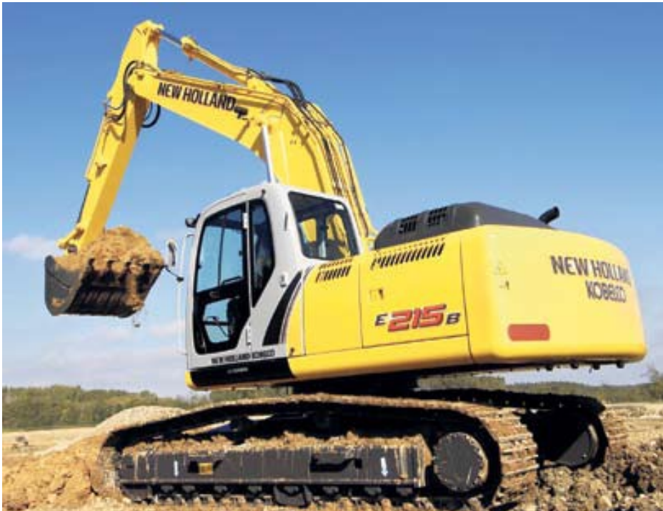
Der E215 B von New Holland. Im Ergebnis bewegt die neue Maschine rund 15% mehr Kubikmeter Erreich pro verbrauchtem Liter Dieselmotorkraftstoff als sein Vorgängermodell
